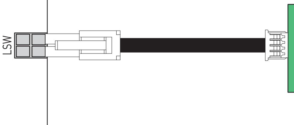
**IT** Collegare il finecorsa magnetico al quadro elettronico mediante il cablaggio in dotazione. Attivare dal menù **RP** la funzionalità finecorsa desiderata (Menù **FA - FC**).
